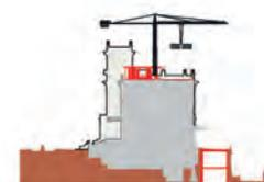
Réalisation de nouvelles structures verticales et horizontales pour le nouveau volume en surélévation
