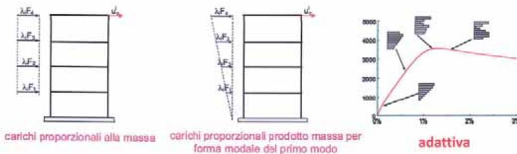
Figura 21 - Opzioni correnti per la determinazione delle azioni orizzontali.
